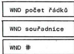
První tvar příkazu rozděluje obrazovku na dvě části (horní - rezervovanou, dolní přístupnou pro zobrazení). Tento příkaz je dílčím tvarem druhého tvaru se souřadnicemi a je uveden samostatně, protože byl zaveden v Basice EX V4.0.
