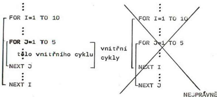
Další důležitou zásadou u cyklů je princip výstupu z cyklu výstupním bodem, tj. příkazem NEXT (resp. UNTIL, WEND). Výstup z cyklu jiným způsobem (např. GO TO) může vést k chybě programu. Proto pokud chcete předčasně ukončit cyklus, změňte řídící proměnnou cyklu tak, aby byla splněna podmínka pro výstup cyklu a skočte na příkaz konce cyklu.
